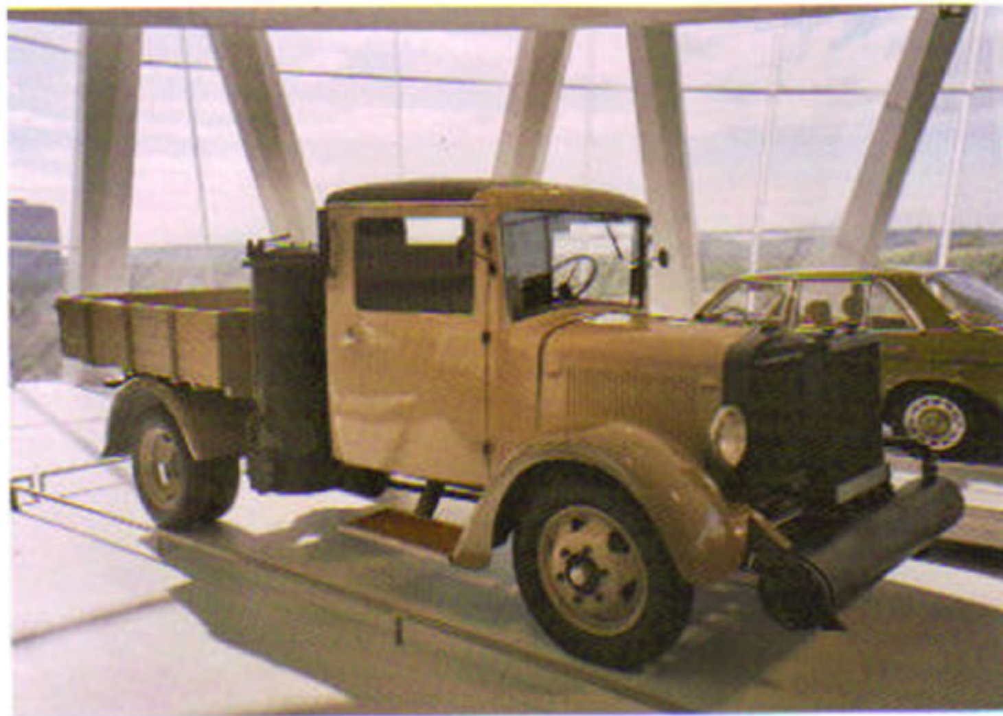
Camió Mercedes-Benz L 1500 (1937), equipat amb un gasògen. Museu Mercedes-Benz, Stuttgart (Alemanya). (Fotografia de l'autor)
